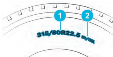
Markierung von Reifengröße und Tragfähigkeitsindex am Reifen
